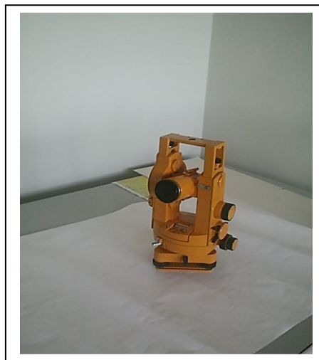
Figura 15: Teodolito ótico-mecânico. Versão mais moderna
