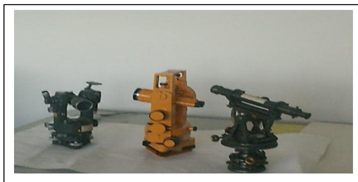
Figura 16: ilustração comparativa da evolução tecnológica dos teodolitos ótico-mecânicos
