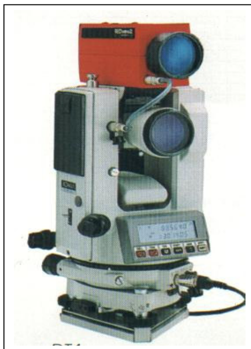
Figura 46: Modelo mais moderno de MED acoplado a um teodolito eletrônico, porém com sistemas operacionais independentes.
