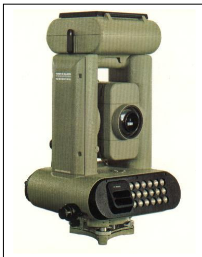
Figura 32: Taqueômetro eletrônico de redução, marca Wild (acoplado com MED)
