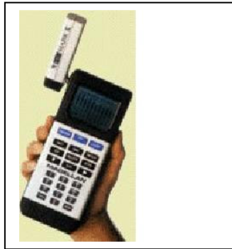
Figura 49: Receptor GPS com precisão métrica
