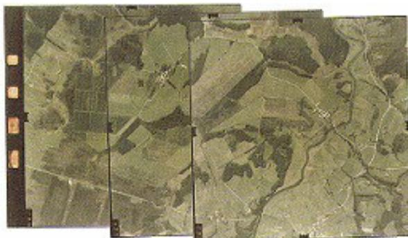
**Figura 17:** Verificação da presença de deriva no vôo
